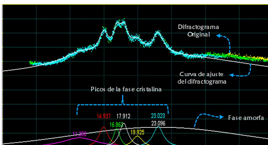
Figura 4.1: Curva característica obtenida por difracción de rayos X. La curva original es deconvolucionada a fin de obtener la fase amorfa y la fase cristalina. La curva de ajuste es integrada, y las áreas son comparadas.
