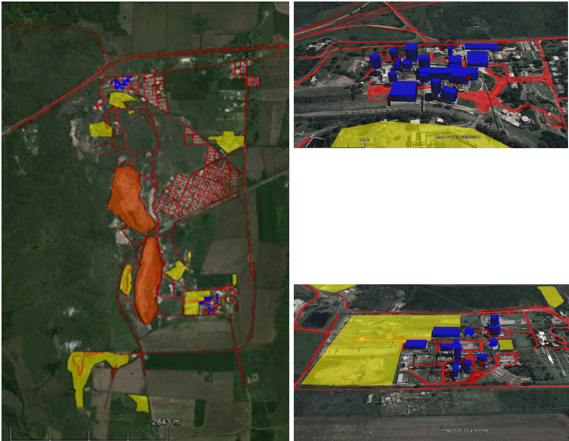
Figura 2.6. Fuentes de emisión de TSP ingresadas al modelo AERMOD para el área de Malagueño.
