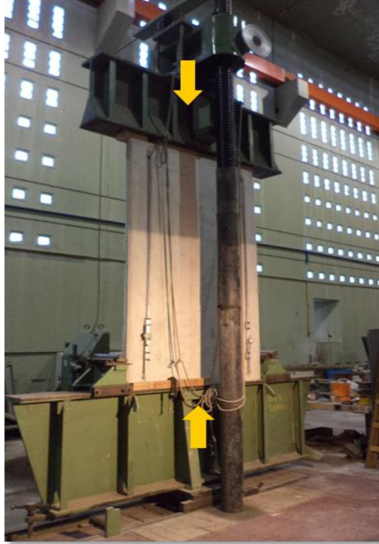
Figura 12.7. Detalle Dispositivo para Ensayo IRAM 11.588.
