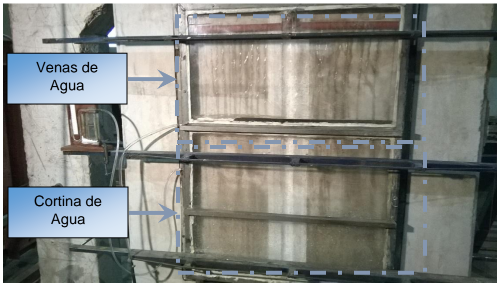
Figura 12.25. Detalle de Cámara para Ensayo ASTM E – 514.
