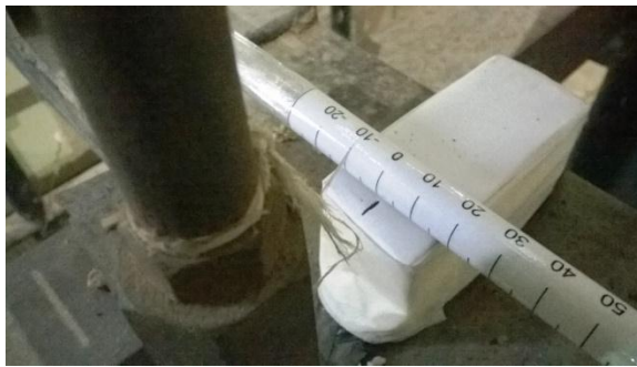
Figura 12.20. Detalle Dispositivo para medir Deflexiones en Ensayo IRAM 11.596.
