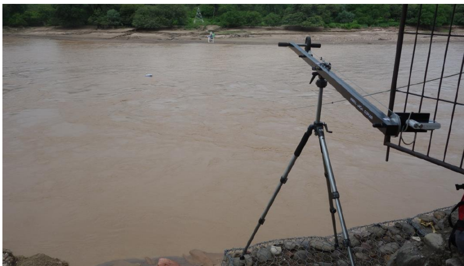
Figura 262.- Configuración del sistema para la implementación de la técnica de PIV. La cámara digital se ha montado sobre una grúa desde la margen izquierda del río (Szupiany, y otros 2014).
