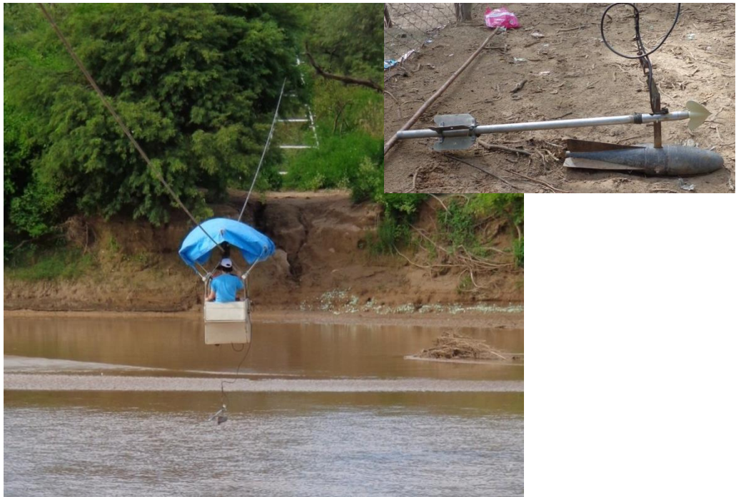
Figura 244.- Aforo con Molinete sobre vagoneta. Sección MLP, enero 2014 (Cristanchi y Testa Tacchino 2014).
