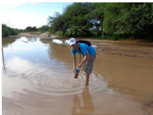
Figura 247.- Llenado de botellas para aforo con flotadores, enero 2014 (Cristanchi y Testa Tacchino 2014).
