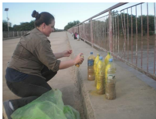
Figura 248.- Preparación de botellas para el aforo con flotadores, enero 2014 (Cristanchi y Testa Tacchino 2014).
