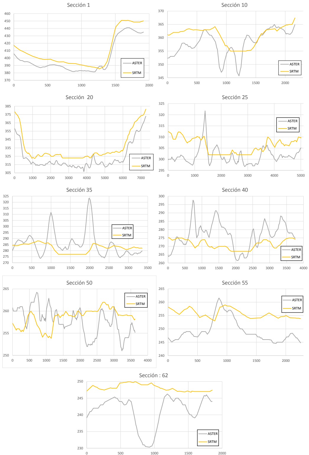
Figura 105.- Comparación de topografías extraídas de ASTER GDEM y SRTM en Diferentes secciones transversales a lo largo del Río Pilcomayo
