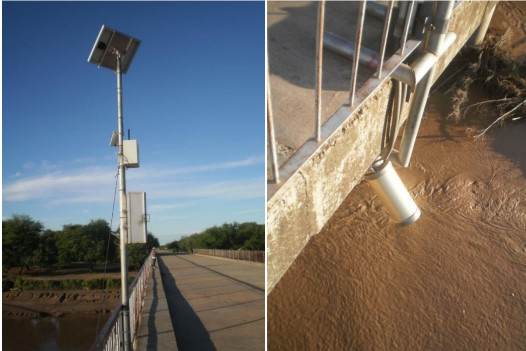
Figura 251.- Izq.) Sensor del Kalesto. Der.) Panel solar y Panel de Control y transmisión de datos del Kalesto (Cristanchi y Testa Tacchino 2014).
