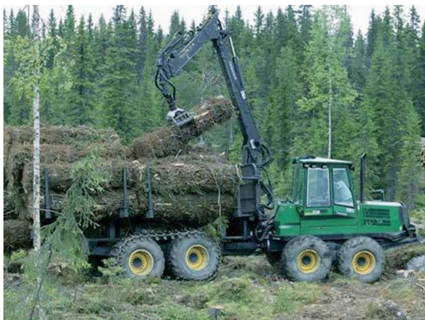
Ilustración 9: Forwarder recolectando fardos de ramas. Fuente: Dr. Augusto Uasuf, Ing,Agr. Jorge Hilbert., informes Técnicos Bioenergía
