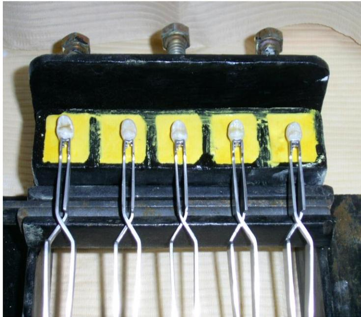
Figura 11 A: para fuerzas: OA= Posicionador de bracket: se observa el elemento dentario con su bracket en las diferentes celdas portadoras de brackets previo a la realización del ensayo final.
