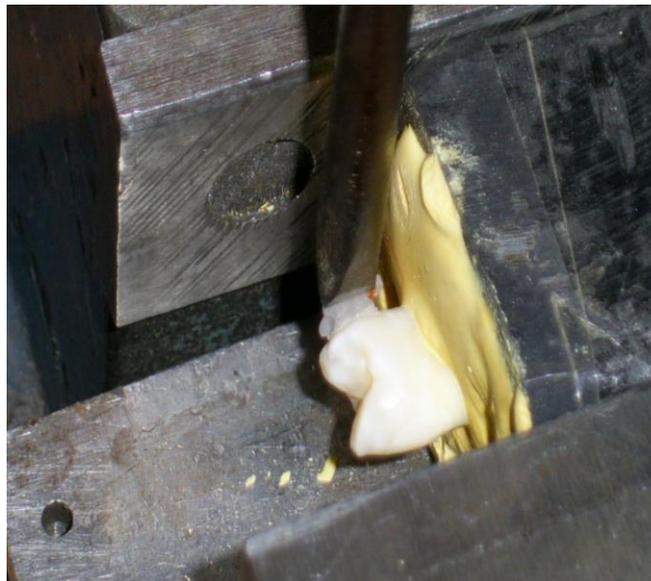
**Figura 15:** lugar de aplicación de la fuerza en los ensayos mesio-distales. Ensayo de cizalla previo a aplicar la carga se debe tener en cuenta el lugar de aplicación (costado de brackets) a la altura de la ranura, la dirección (la línea del cincel) esta paralela a la base del brackets en sentido sagital como en sentido frontal.
