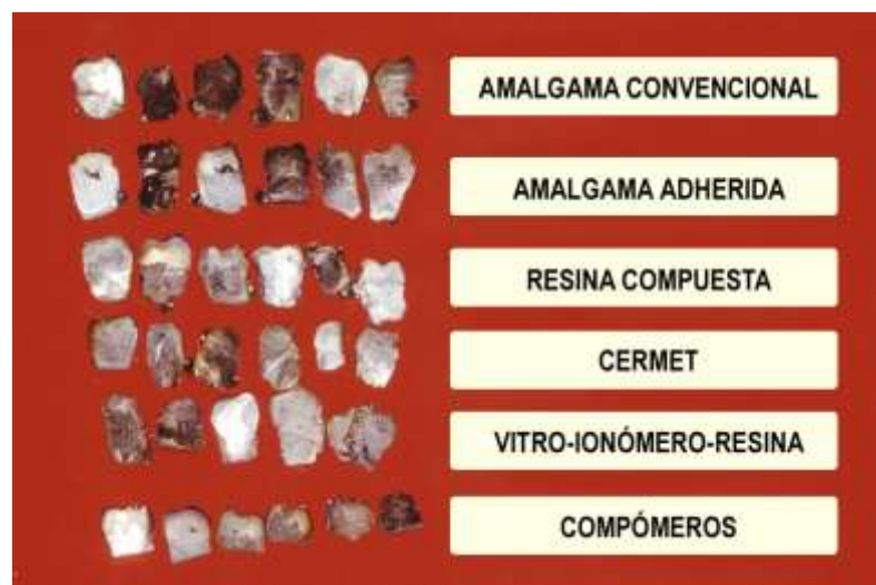
FIGURA 13. Réplicas metalizadas para observación con M.E.B.
