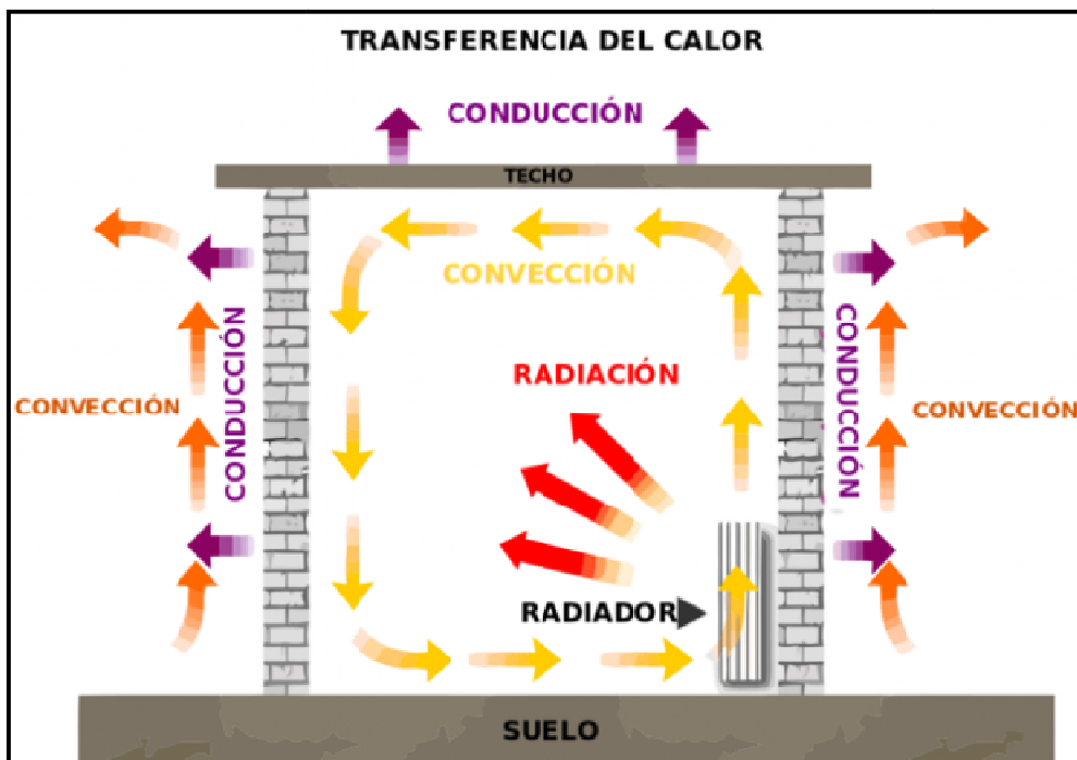
Figura 3.1: Modos de transferencia de calor
