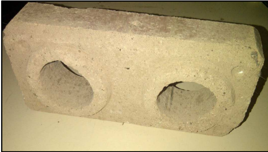
Figura 2. 8: Muestra de ladrillo suelo-cemento estudiado
