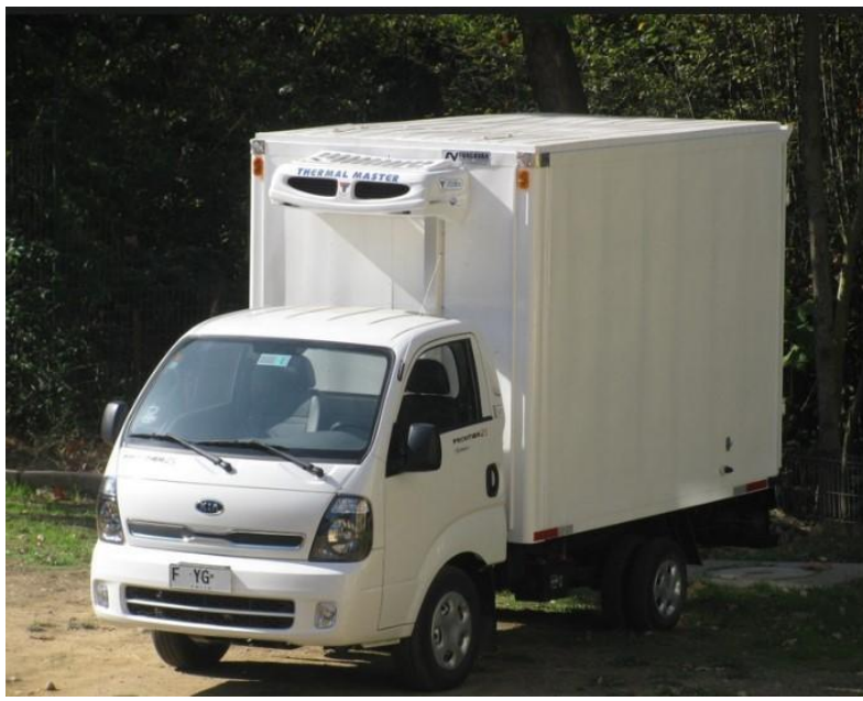
Figura 19: vehículo para el transporte de lechuga hidropónica, con sistema de frío y caja aislada.
