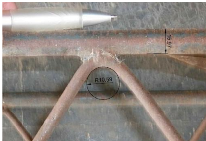
FIGURA 52-Foto barra armada reticulada de 18,4cm x 18,4cm
