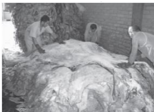
Figura 11: Fotografía Etapa Salado de Pieles. Fuente Guía Ambiental para la Industria del Curtido y Preparación de Cueros. 40
