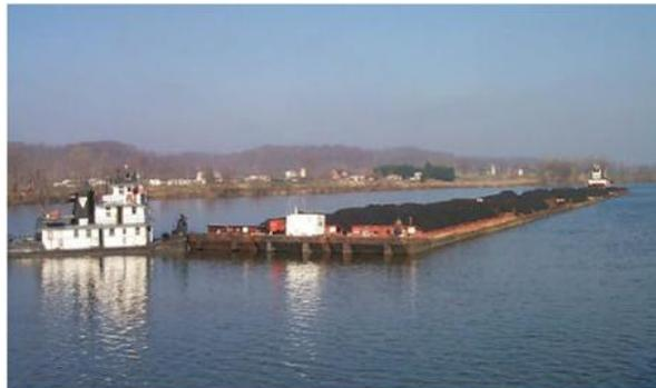
Figura 2.3: Grupo de barcazas para ensayo contra muro de exclusa realizado por el Cuerpo de Ingenieros del Ejército de EEUU (Arroyo y Ebeling, 2005)
