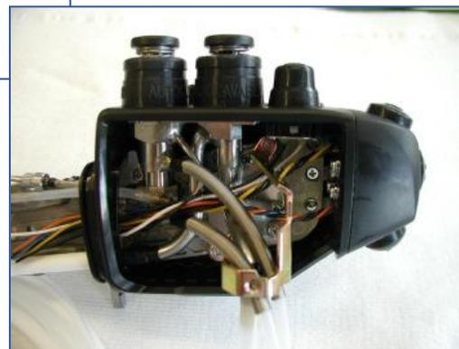
Figura 5. Arriba: Diseño interior del tubo de inserción. derecha: interior del control de mando.
