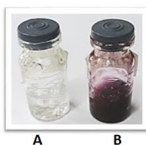
Figura 38. Formulación de gel de Carbopol® en agua MilliQ (A, control), y gel de amoxi@AuNP (B), en viales de vidrio para estudios de estabilidad acelerada.
