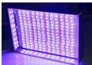
Figura 17. Panel de iluminación LED construido ad hoc , de 23,5 x 16,5 cm. Irradiancia ( \text{W}/\text{m}^2 ): 216,65.
