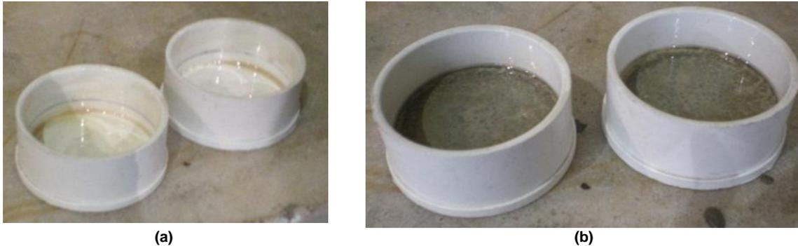
**Figura 28:** a) Tapones de PVC utilizados como moldes. b) Moldes de PVC con mortero de hormigón autonivelante de alta resistencia.
