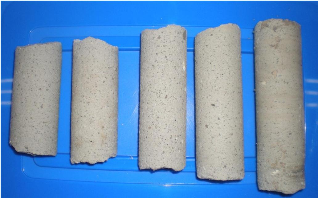
**Figura 23:** Muestra de toba volcánica luego de la extracción de testigos.
