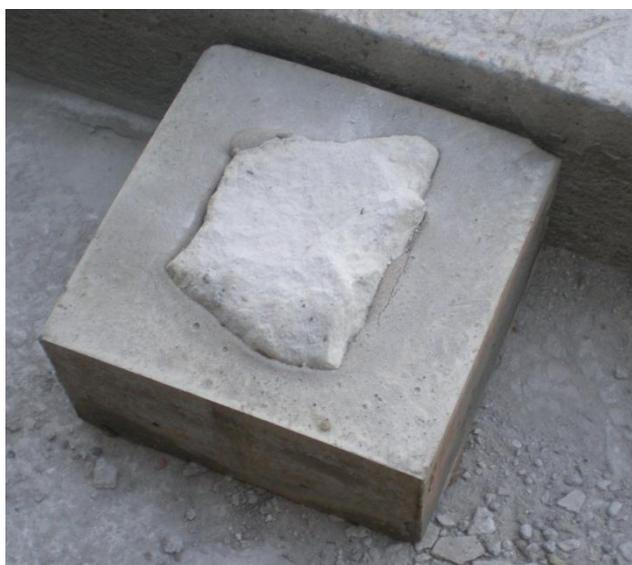
**Figura 20:** Muestra de toba volcánica confinada en el molón de hormigón.
