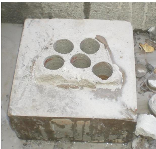
**Figura 22:** Muestra de toba volcánica luego de la extracción de testigos.
