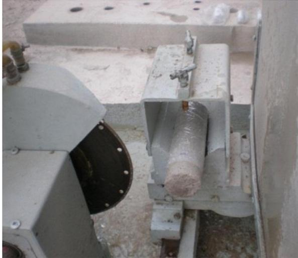
**Figura 25:** Testigo colocado en la prensa para ser cortado con el disco.
