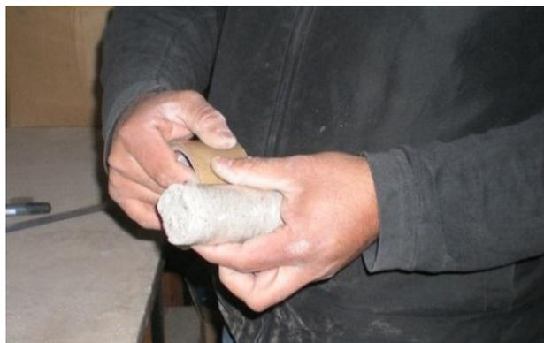
**Figura 24:** Encintado de los testigos previo a ser cortados.
