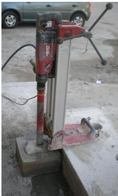
**Figura 21:** Perforadora fijada al dado de hormigón, colocada sobre el molón de hormigón con muestra de toba volcánica.
