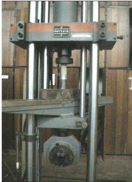
**Figura 26:** Ensayo de compresión simple sobre testigo de toba volcánica.
