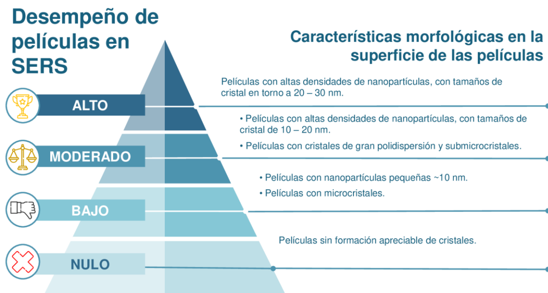
Figura 5.13. Clasificación del desempeño de películas aplicadas en SERS y su correlación con las características morfológicas en la superficie de estas.
