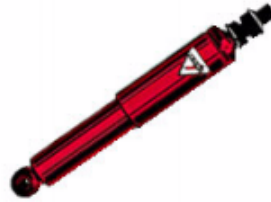
Figura 5.56 Amortiguador telescópico actual (extraído Ref. [5]).
