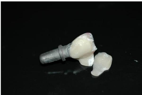
**Figura 47.** Modo de fractura **A**.
