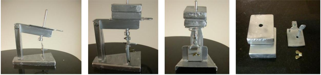
**Figura 21.** Componentes del dispositivo de carga axial para cementado.
