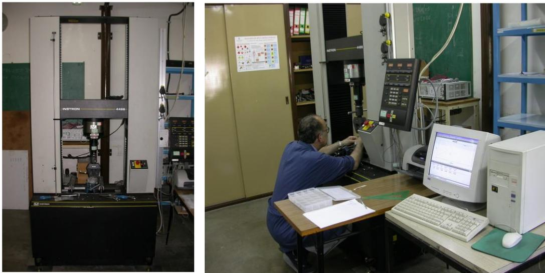
**Figura 27.** Medición de la resistencia a la fractura. Máquina universal de ensayos Instron 4486.
