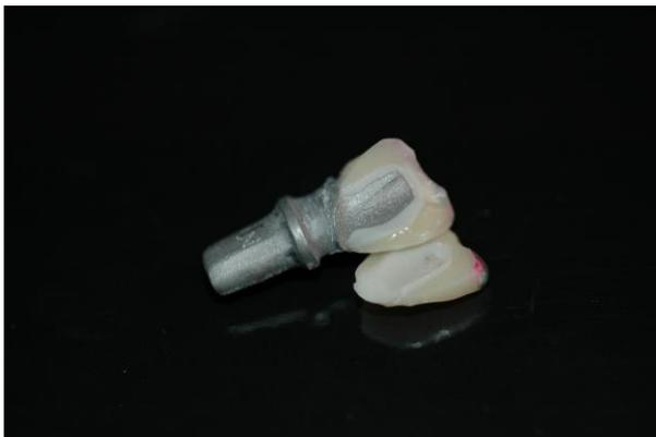
**Figura 51.** Modo de fractura D2.
