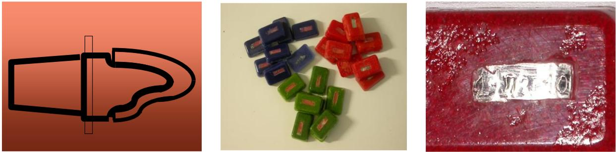
**Figura 20.** Muestras cementadas, incluidas en resina.
