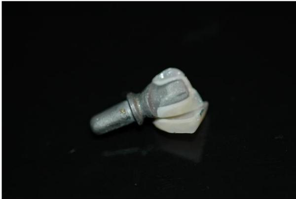
**Figura 52.** Modo de fractura **D1**.
