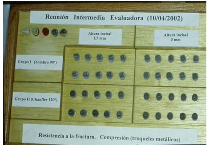
**Figura 8.** Estuches de cada sistema para remitir al laboratorio, con sus correspondientes identificaciones e indicaciones.
