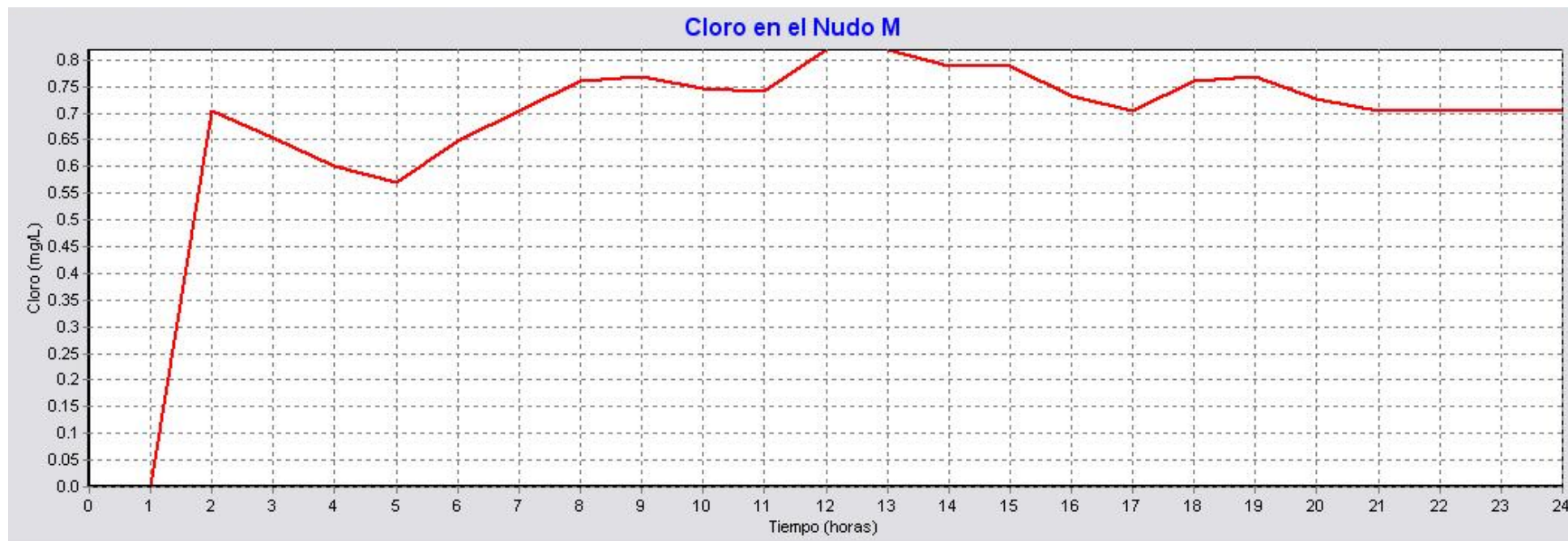
Figura 5. 11: Curva de evolución temporal de cloro en el nudo M ( k = -4,74 \text{ día}^{-1} , Cl = 1 \text{ mg/l} )
