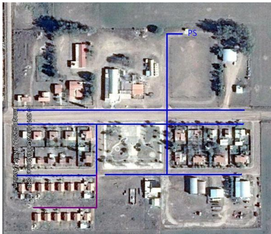
Figura 5.2: Esquema de la red de distribución de agua de Colonia Las Pichanas al final del período de diseño.
