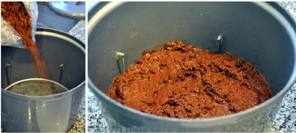
Figura 4.31: Compartimento superior con suelo reactivo
