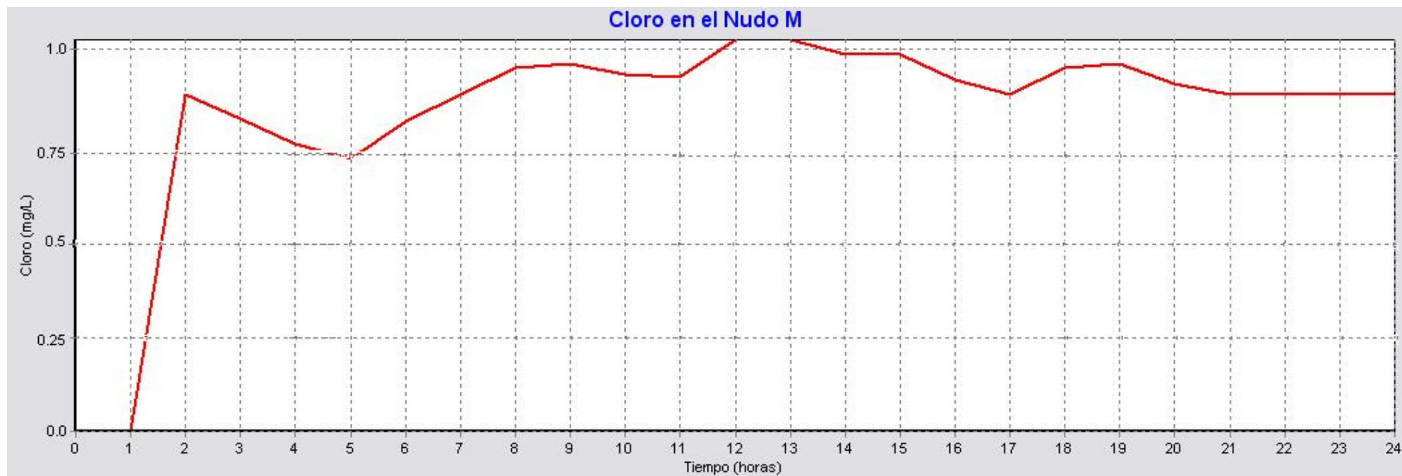
Figura 5.13: Curva de evolución temporal de cloro en el nudo M ( k = -4,74 \text{ día}^{-1} , Cl = 1,25 \text{ mg/l} )
