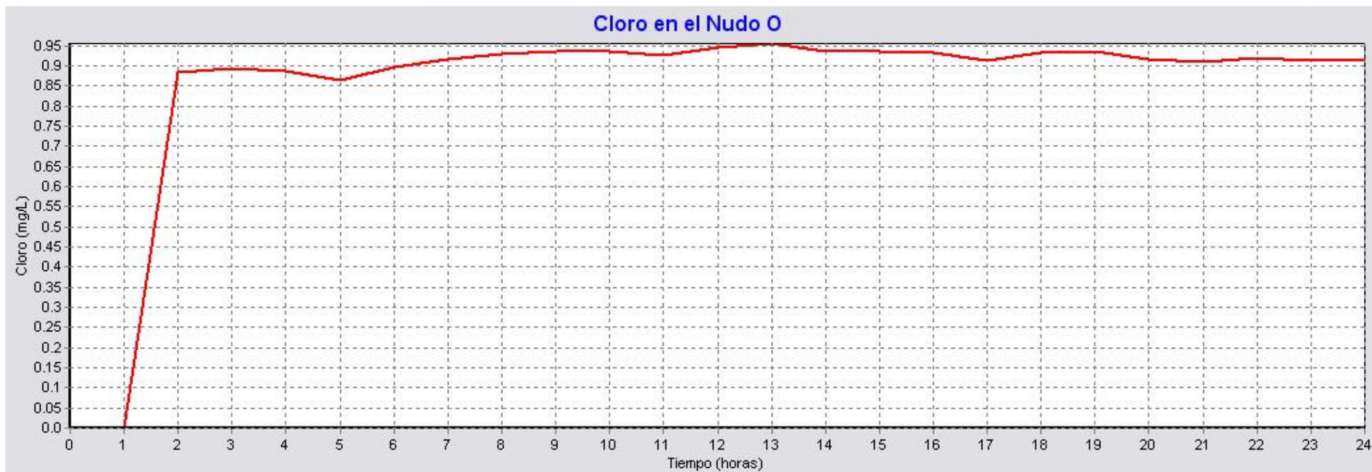
Figura 5. 17: Curva de evolución temporal de cloro en el nudo O ( k = -1,18 \text{ día}^{-1} , Cl = 1 \text{ mg/l} )
