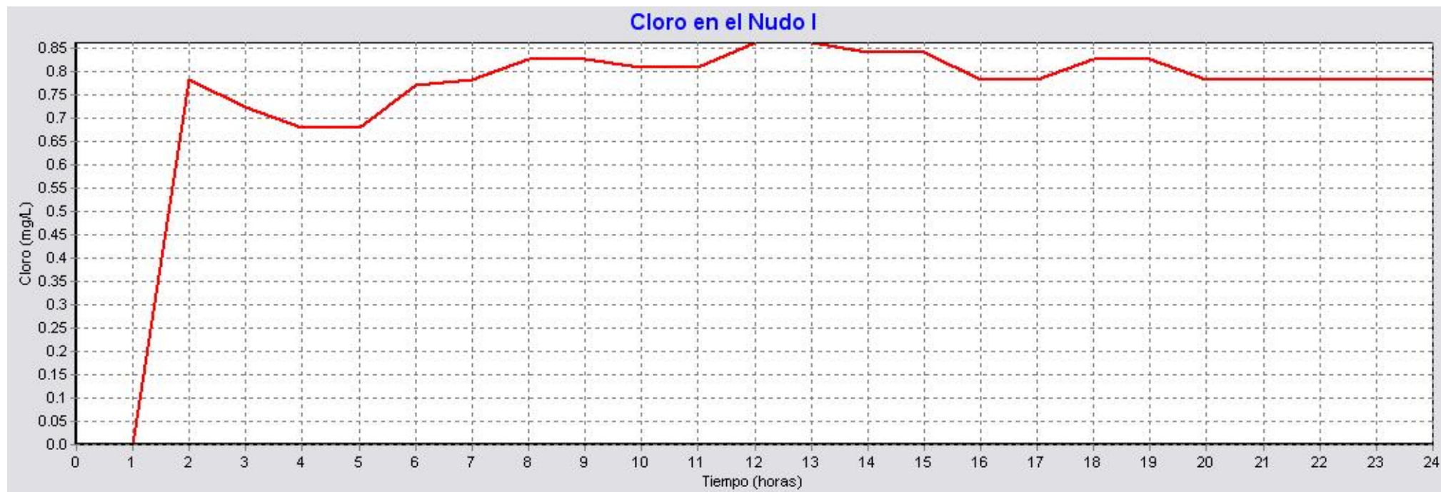
Figura 5.21: Curva de evolución temporal de cloro en el nudo I ( k = -4,74 \text{ día}^{-1} , Cl = 1 \text{ mg/l} )
