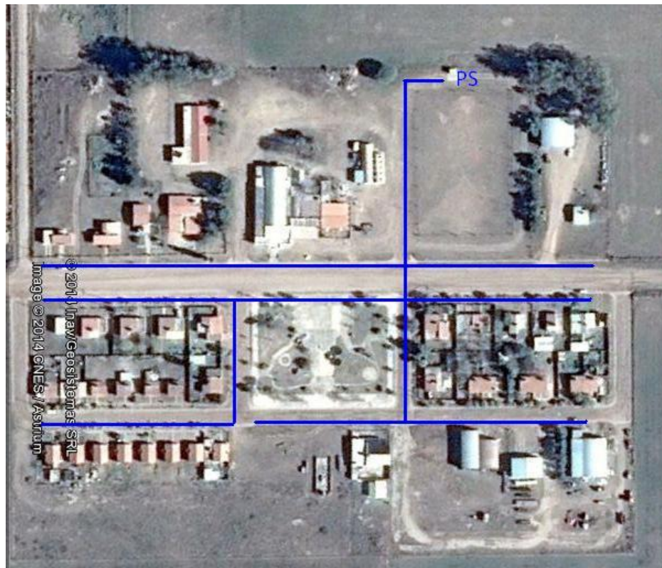
Figura 5.1: Esquema de la red actual de distribución de agua de Colonia Las Pichanas.
