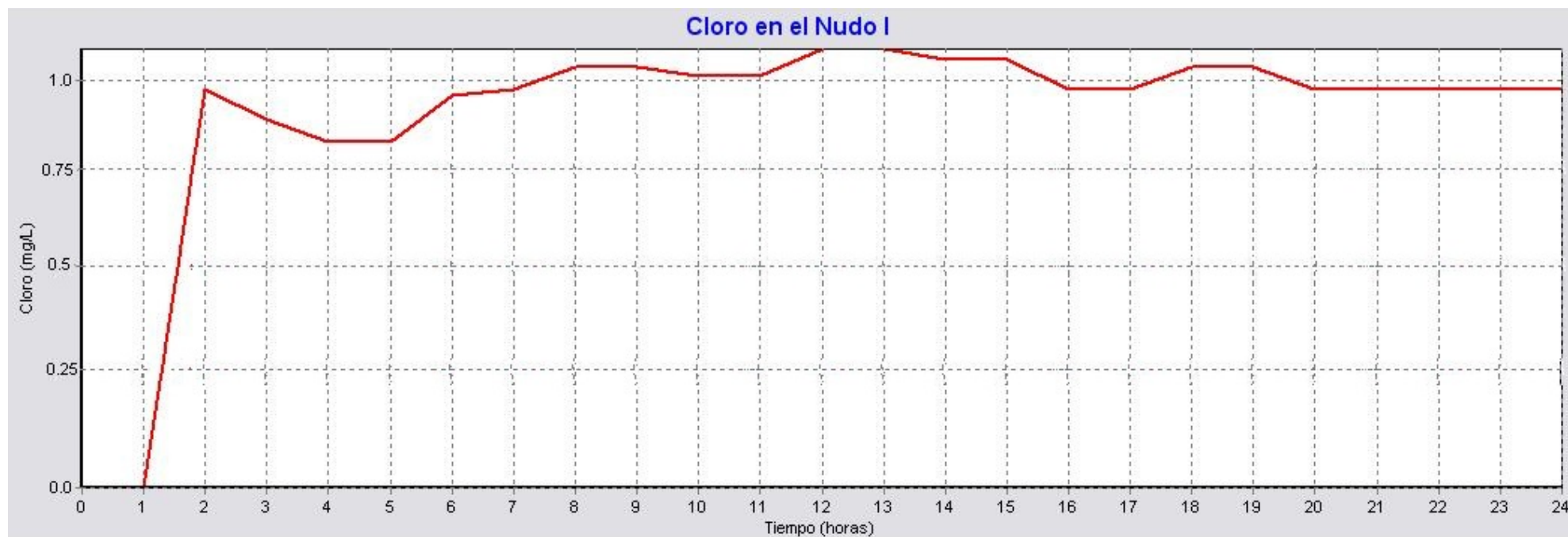
Figura 5.14: Curva de evolución temporal de cloro en el nudo I ( k = -4,74 \text{ día}^{-1} , C_i = 1,25 \text{ mg/l} )
