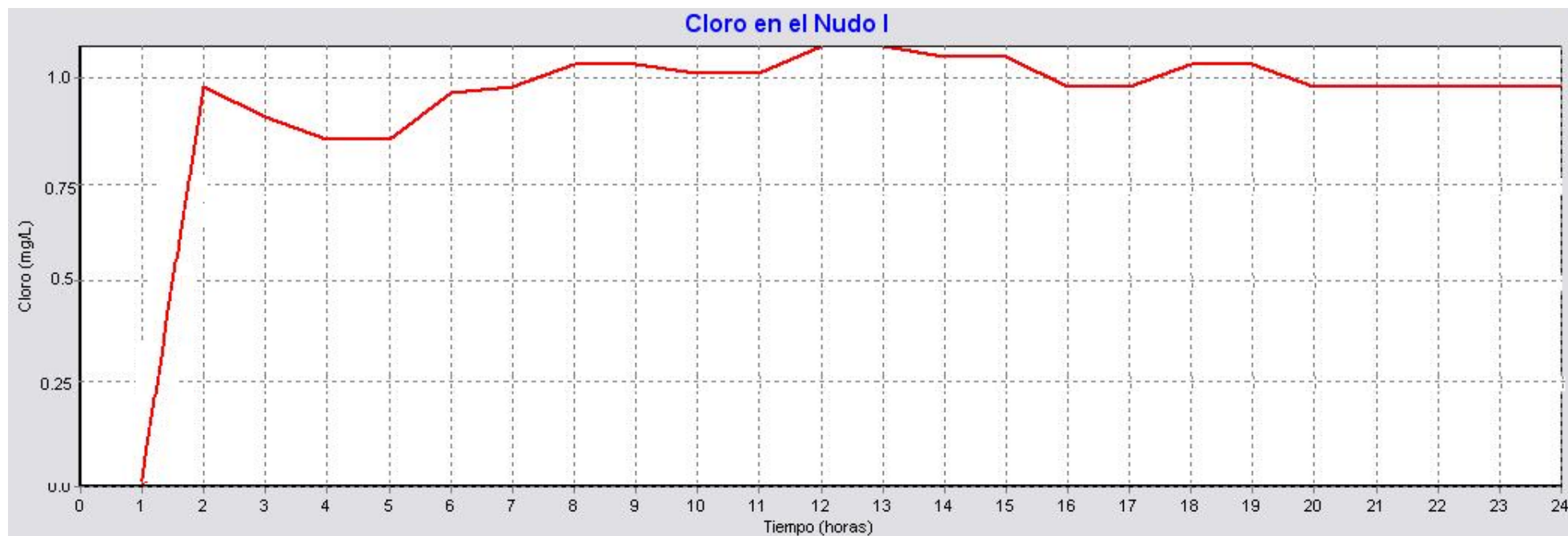
Figura 5.24: Curva de evolución temporal de cloro en el nudo I ( k = -4,74 \text{ día}^{-1} , Cl = 1,25 \text{ mg/l} )
