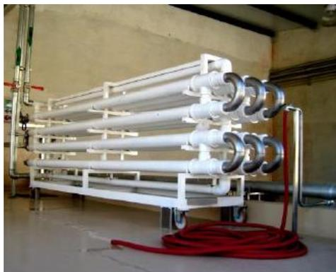
De acuerdo a lo solicitado, procedemos a cotizar la provisión de un intercambiador AISI-PVC, para vendimia con tubo interior en AISI de diámetro 101 y exterior en PVC, de diámetro 140 K-10, formado por un conjunto de 8 tubos de 6 mts, en formato 2x4, con una entrada y una salida de producto, al igual que en el circuito de agua.
