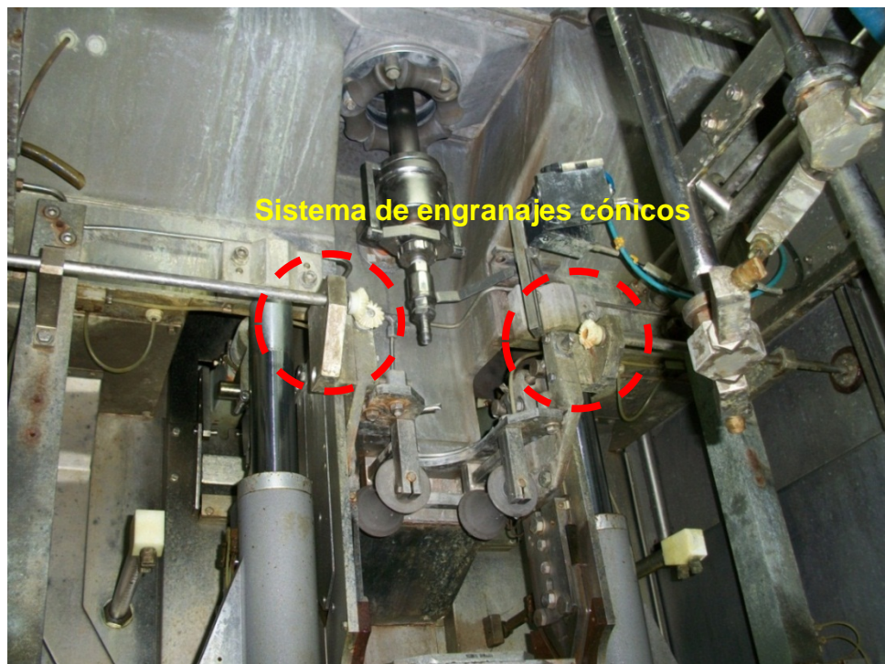
Figura 4-27: Sistema de engranajes cónicos de cada mandíbula.
