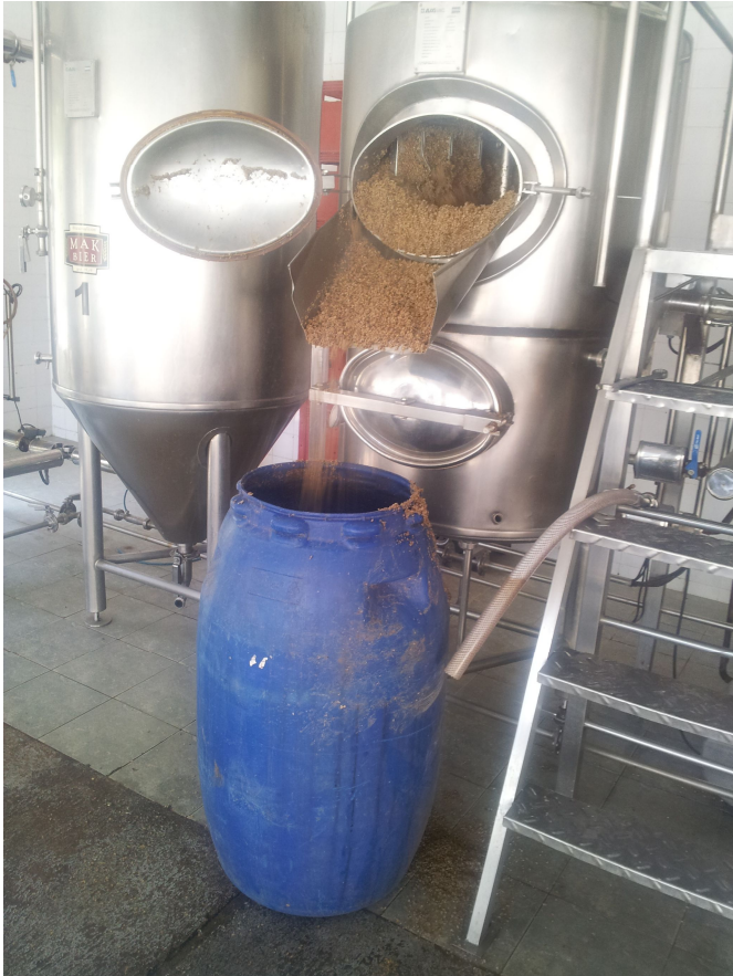
Figura 11: Macerador y grano ya macerado que no se desperdicia.
