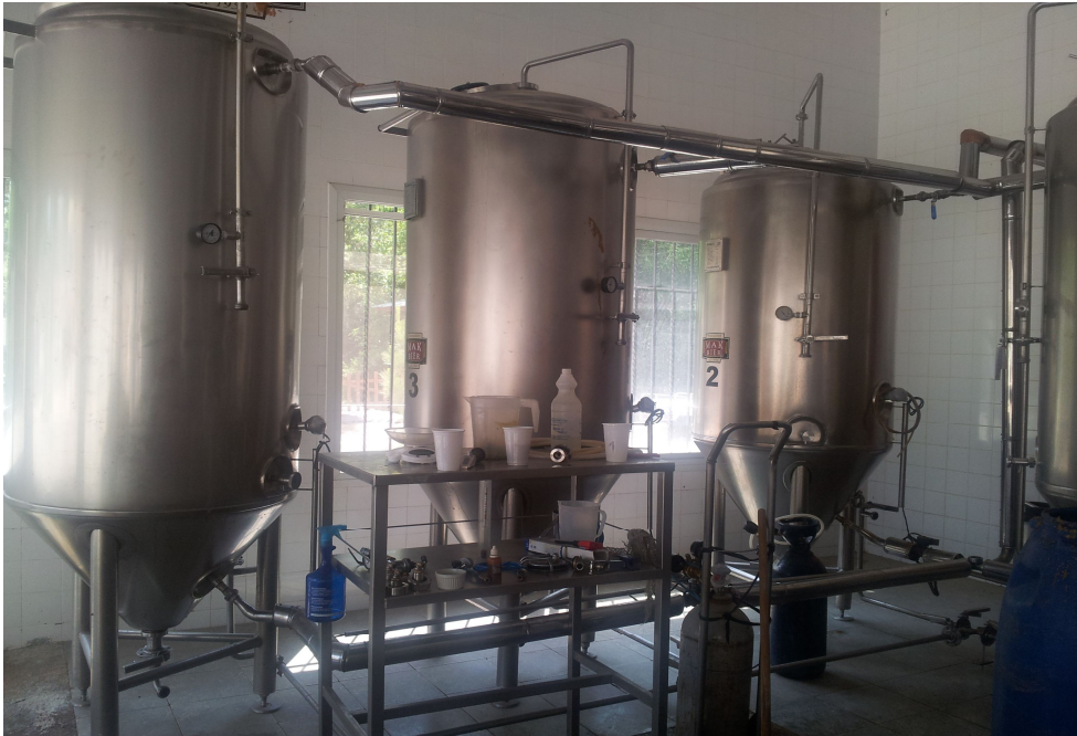
Figura 13: Tanques fermentadores de 400 litros.
