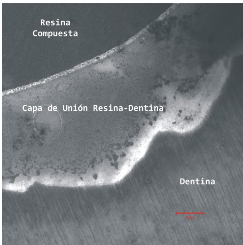
Figuras 56 y 57: Microfotografías de ángulos axio-cervicales con el adhesivo monomérico. Se observa un aumento localizado del espesor de capa a nivel del ángulo, relacionado con la técnica de aplicación del material. Confocal Laser Scanning Microscope.
