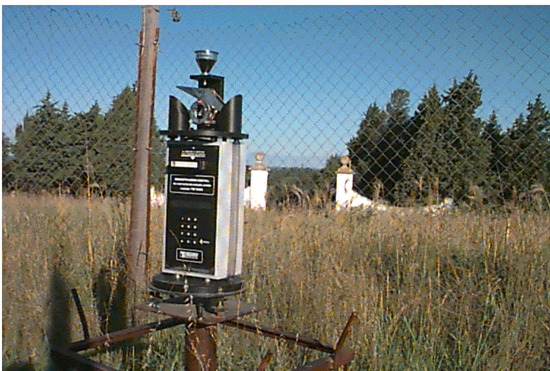
Figura II.15- Pluviógrafo Oeste sin la cubierta protectora
