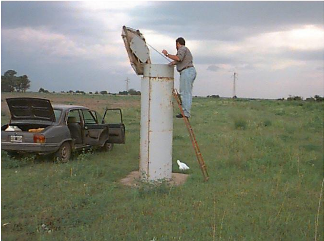
Figura II.23- Limnógrafo de Cuenca Grande en el canal de desagüe de la cuenca.
