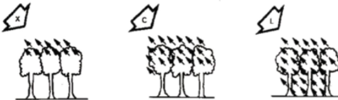
**Figura 2.2:** Profundidad de penetración diferentes longitudes de onda
