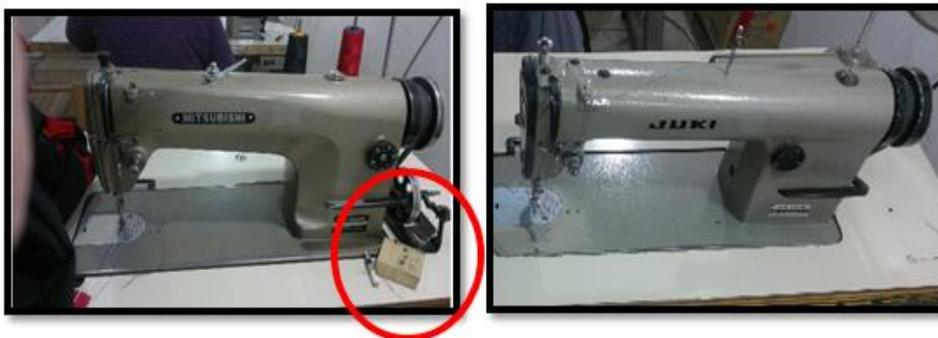
Se observa en la Fig. 3 el recorrido de los operarios, para recargar la bobina; sacando el carrete de la M.C.R, para luego transportarlo hacia la otra M.C.R (que se utiliza de apoyo en esta operación), para bobinarlo nuevamente con hilo. Durante este operación se produce una demora de 10 minutos cada 20-15 minutos de funcionamiento nominal de la maquina en producción, y este proceso, no resulta para nada práctico.
