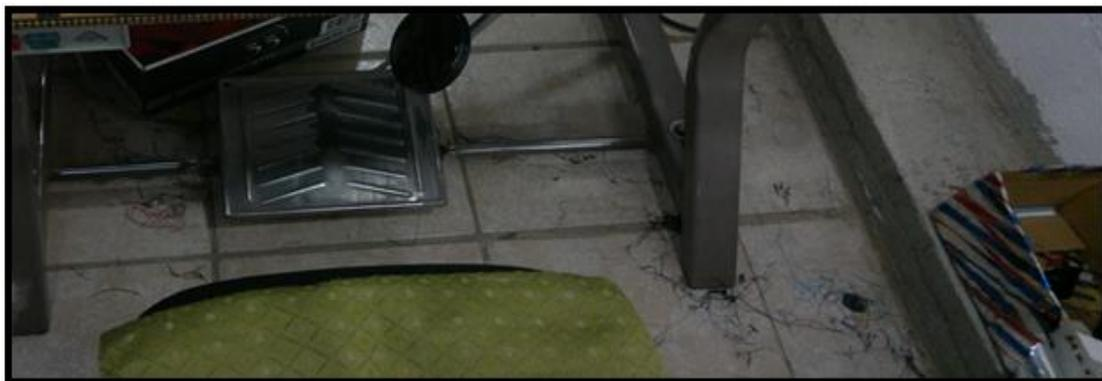
Recipiente de cartón mal ubicados y no adecuado para depositar scrap de material que aporta peligrosamente combustible sólido en el caso de un siniestro.
