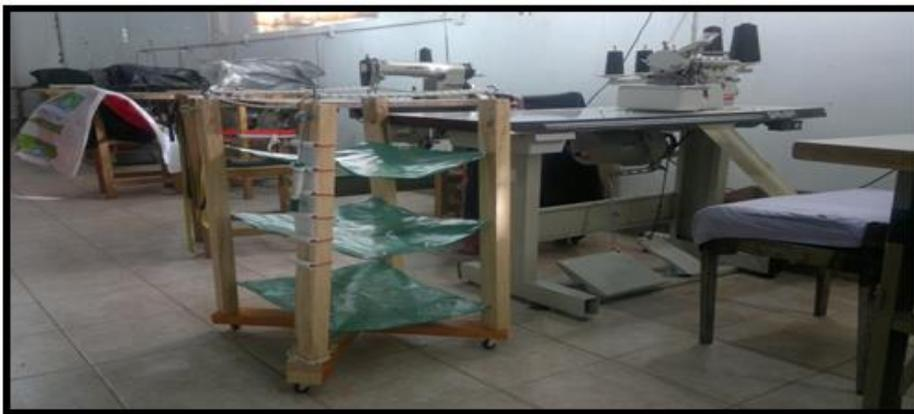
Se muestran los puestos totalmente aseados, con las maquinas tapadas, y otras destapadas para comenzar a trabajar. También se aprecia uno de los tantos carritos móviles prácticos, por ser plegables, que se diseñó para transportar los cortes e insumos de la mesa de corte hacia los puestos de trabajo.
