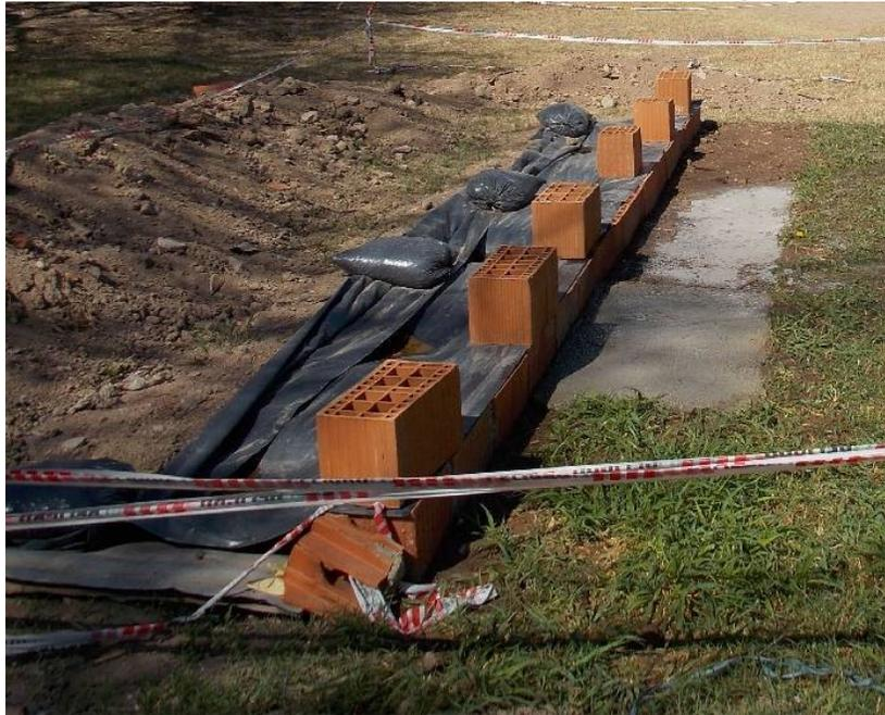
Fig. 7- Modelo físico a escala natural finalizado con la disposición de las barreras y la cobertura del terreno natural en la parte posterior del muro de bloques cerámicos.
