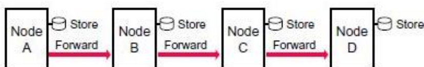
Figura 3.1: Almacenamiento y reenvío de datos empleado por los nodos en las DTNs. [28]
