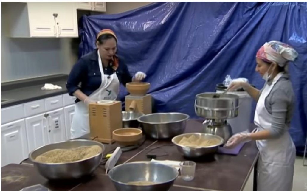
Figura 12: Molienda y tamizado de harina de bagazo cervecero.
