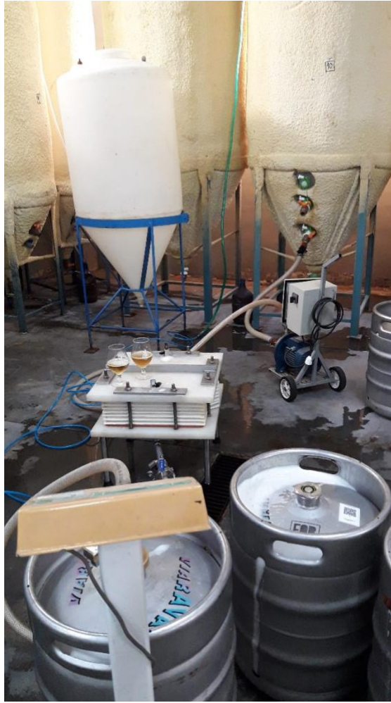
Figura 9: Filtrador en placas de la cervecería Viarava.
