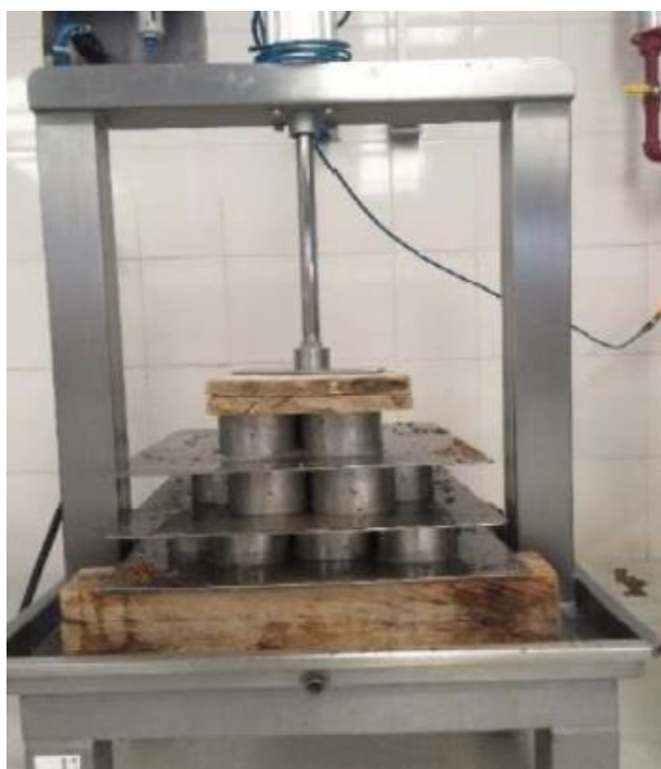
Figura 10: Prensado del bagazo cervecero con prensa hidráulica.
