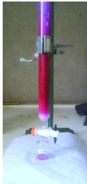
Figura 2.3: Cromatografía en Columna. A) CR puro; B) CV puro.
