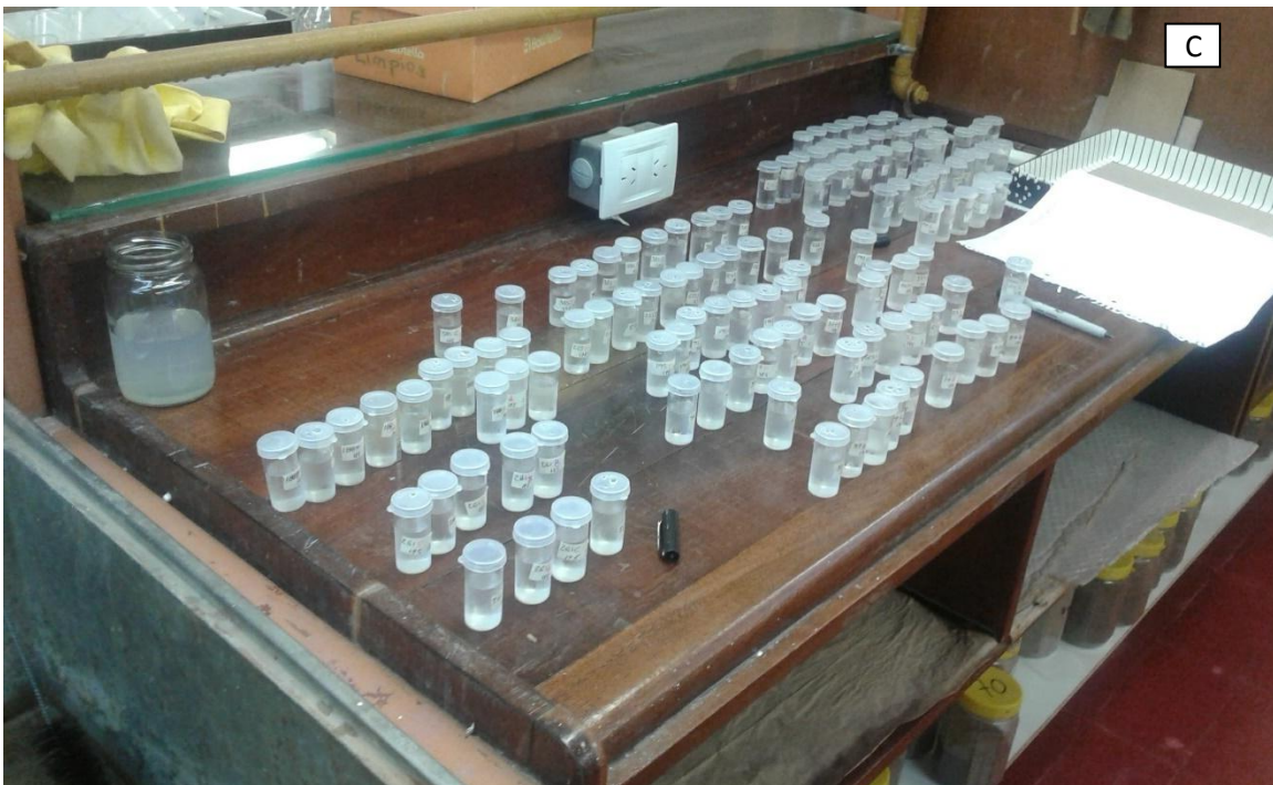
Figura A) Foto de la parte exterior de la sala de acondicionamiento de suelos, utilizada para tamizar, B) Frasco grande utilizado para realizar las incubaciones de suelo, en la imagen se observa dentro el suelo y los frascos pequeños con NaOH y agua, C) frascos con NaOH cerrados, extraídos de una fecha de incubación y listos para su titulación.
