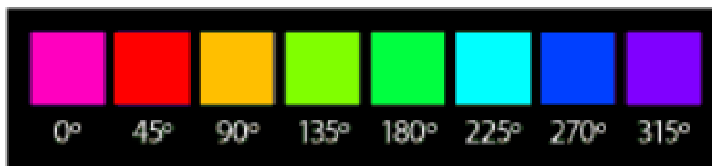
Figura 2. 7. Tonos correspondientes a los distintos ángulos de matiz o tono son, expresados en grados sexagesimales.
