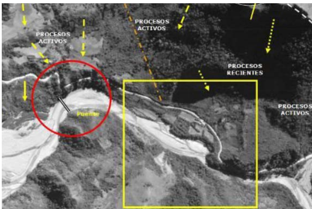
Figura 3.8. Sector estable detectado aguas debajo del puente actual
