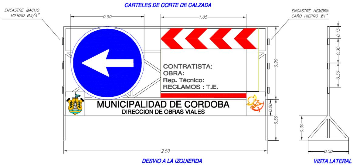
Fig. 3.2.1 Esquema de cartelería para desvío.
