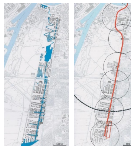
Fig. 151 Recuperadas de: https://upcommons.upc.edu/ Diagramas de infraestructuras sobre el eje de crecimiento llamado Ørestad. A la izquierda, en azul, se muestra el recorrido irregular de la infraestructura de agua, formando canales, plazas y lagunas, configurando un parque lineal. A la derecha, el eje de infraestructura de transporte público, serpenteado por el eje paisajístico de agua.
