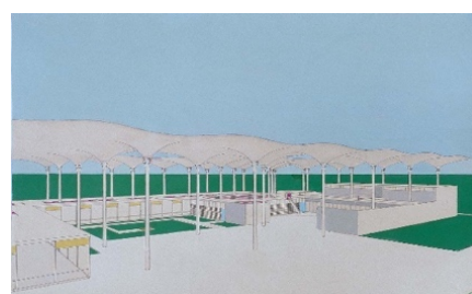
Fig. 128 Recuperada de: https://www.amanciowilliams.com/ Proyecto de arquitectura sistémica para tres Hospitales en Corrientes, proyecto no construido del Arq. Amancio Williams. Una sombrilla modular y repetitiva cubre una estructura de forma ortogonal conformada por ambientes seriados, donde se plantea la posibilidad de flexibilidad funcional en el tiempo.
