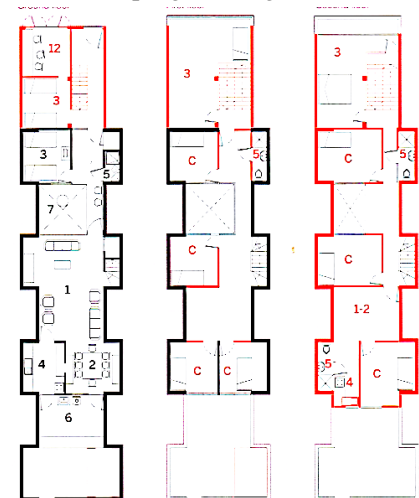
Fig. 390 Tomada del libro: (GARCÍA-HUIDOBRO, Torres Torriti, & Tugás, 2008) Plantas transformadas en hostel por el habitante.
