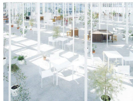
Fig. 302 Recuperada de: https://www.designboom.com/architecture/junya-ishigami-kait/ La estructura de columnas metálicas de diferentes dimensiones y disposición, posibilitan distintas escalas de espacios y diversidad de actividades. Nótese también, la iluminación cenital que remarca la idea de inmaterialidad espacial.
