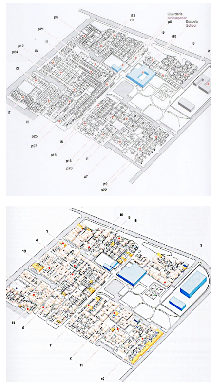
Fig. 375 Tomada del libro: (GARCÍA-HUIDOBRO, Torres Torriti, & Tugas, 2008) Axonometría del conjunto PP1 en su etapa de obra formal, proyecto inicial realizado por profesionales (arriba) y su transformación en el tiempo por los propios habitantes a través de la obra informal (abajo).
