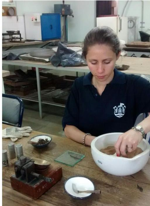
Figura 4.1: Equipo necesario para determinación del Límite Líquido y Plástico.
