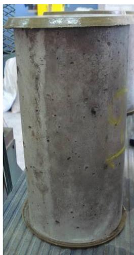
Figura 4.10: Probeta de hormigón para ensayo.
