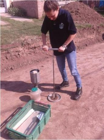
Figura 4.6: Ejecución del pozo sobre subrasante.
