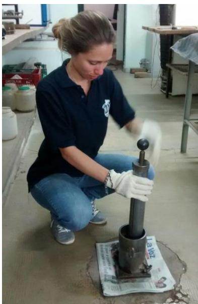
Figura 4.3: Ensayo de Compactación.
