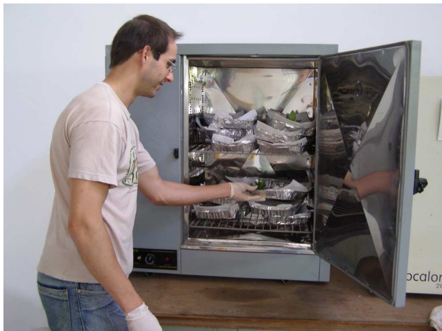
Figura 2.6. Detalle de la estufa utilizada para obtener las mediciones de peso seco.
