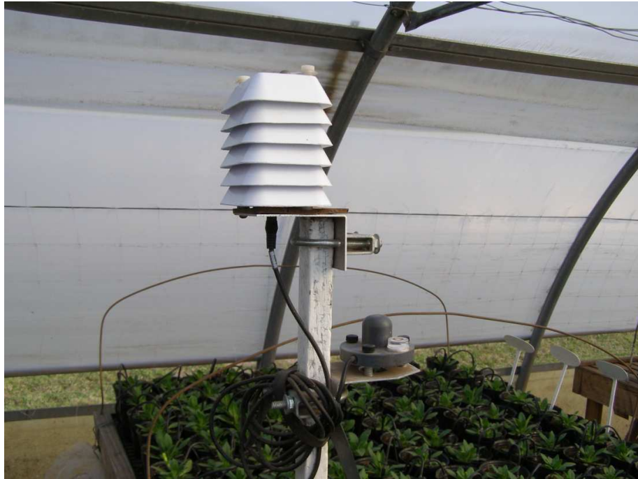
Figura 2.7. Adquisidor de datos Watchdog, con el que se obtuvieron los datos de radiación solar y temperatura del aire.
