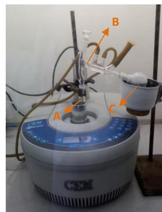
**Figura 1.8.** Diseño experimental para la síntesis asistida por MO de quinolonas. **A)** Adaptador de cuarzo. **B)** Equipo de destilación. **C)** Balón sumergido en N<sub>2</sub> líquido conectado en la salida del refrigerante.
