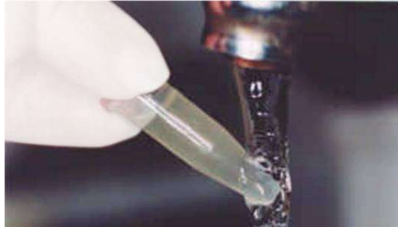
Fig. 11: Se enfrió bajo el chorro de agua corriente con el objeto de disminuir al máximo la presión parcial de oxígeno.
