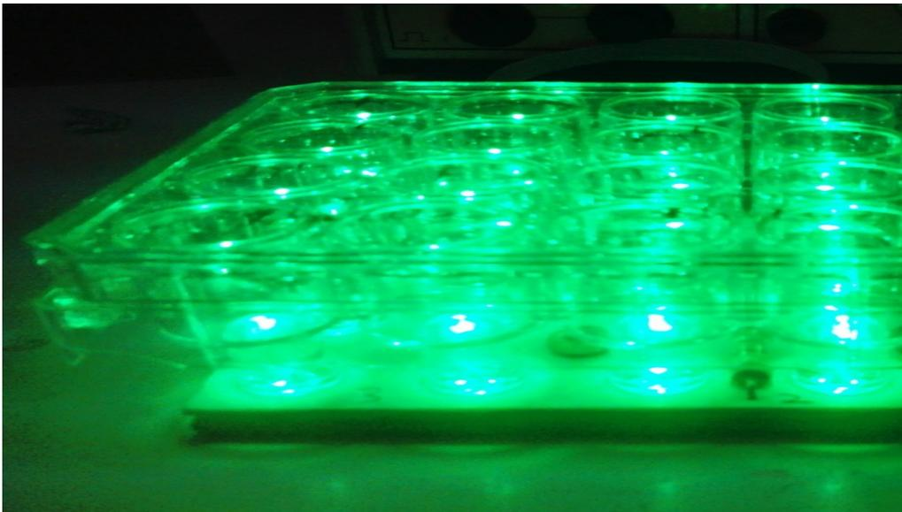
Este arreglo permite irradiar el *wellplate* de forma homogénea y sin generar calor adicional al de la estufa de incubación. La temperatura entre los LED fue medida con un termómetro de mercurio LED y no se observó aumento significativo respecto a los 37 ° C. La
