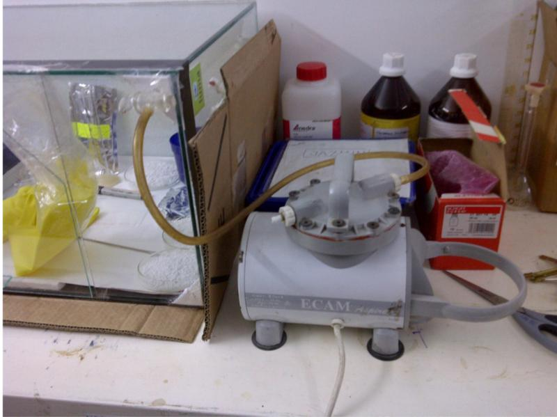
En su interior se colocaron recipientes con  $\text{CaCl}_2$  y con sales de cobalto para comprobar visiblemente el contenido de humedad.
