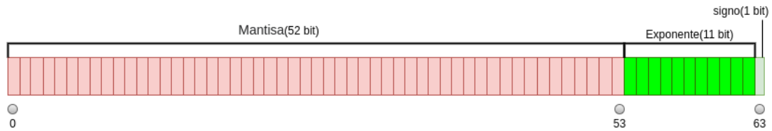
Figura 6.10: Estructura de un número en formato de coma flotante de doble precisión
