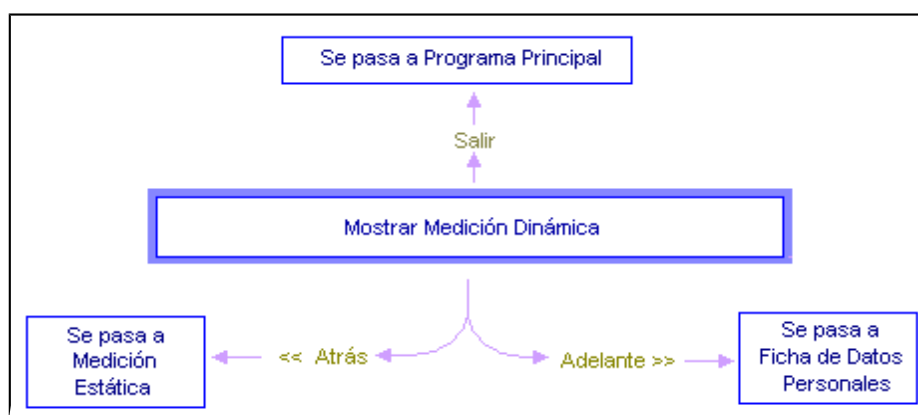
Figura 79. Diagrama en bloques del funcionamiento del subVI “Mostrar medición dinámica”.
