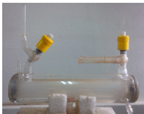
Figura 2.15. Celda de vidrio para descomposición térmica.
