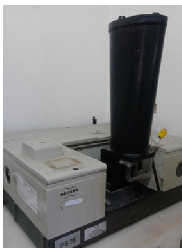
Figura 2.16. Celda de paso óptico largo 9 m.
