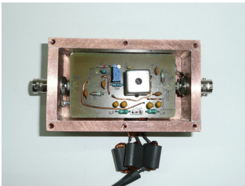
Figura 7.21: Filtro activo de rf construido para el espectrómetro.
