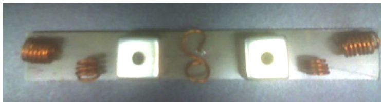
Figura 7.24: Filtro de rf a 60MHz de la etapa de recepción construida para el espectrómetro.
