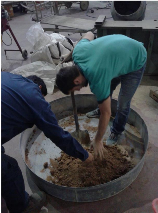
Ilustración 3. Verificación de la consistencia de la mezcla.
