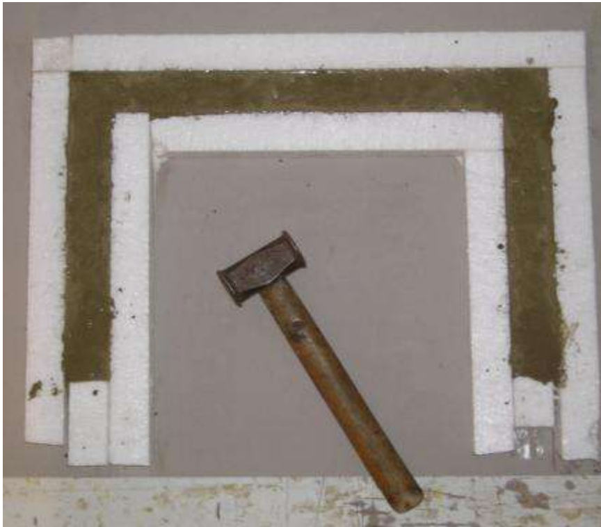
Figura 7. Hormigonado de pórtico y vibrado
