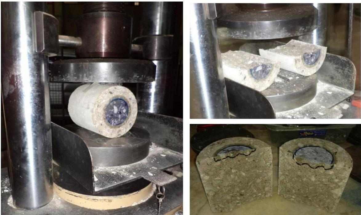
Figura 14: Rotura de probetas y mediciones.
