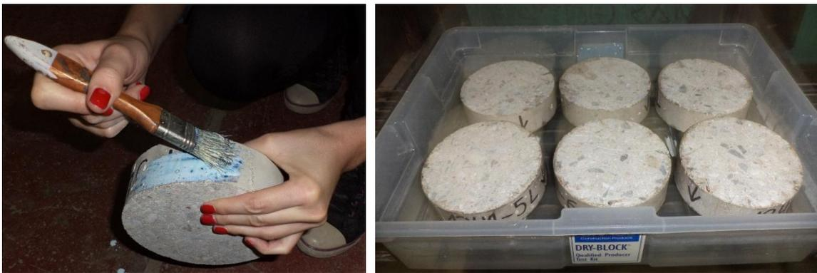
Figura 15: Ensayo de succión capilar.
