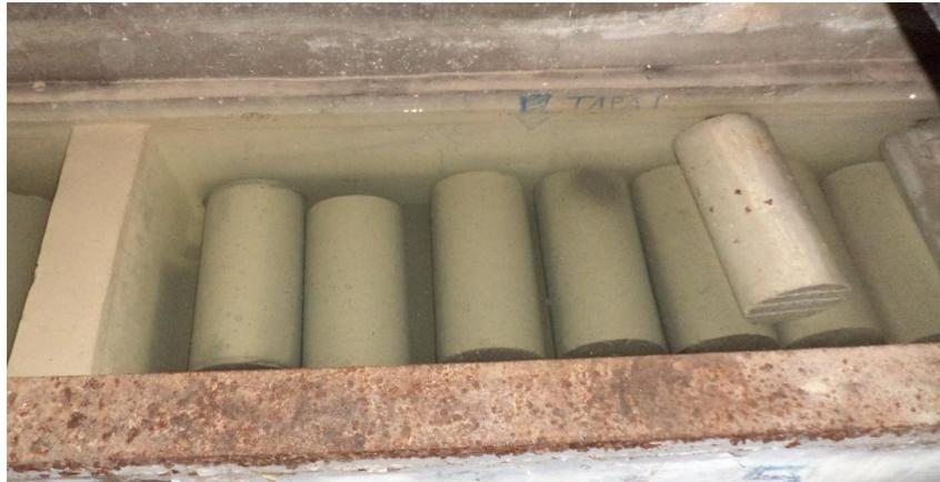
Figura 10: Curado de probetas.
