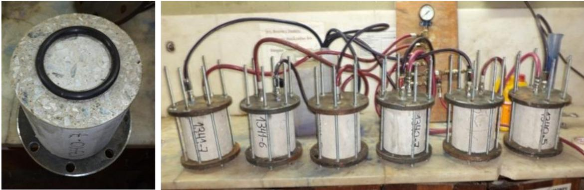
Figura 13: Equipo de penetración de agua a presión.
