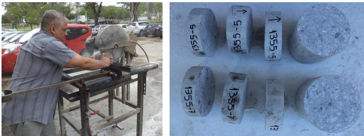
Figura 12: Aserrado de las probetas de ensayo.
