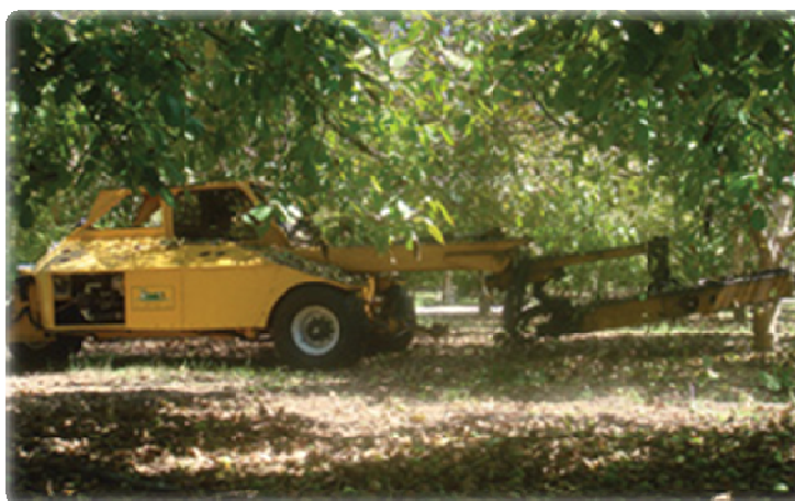
Figura 8. Máquina Vibradora sujetando un árbol de Nogal. . Fuente: Todo Mercado.com, en base a http://www.todomercado.com/
