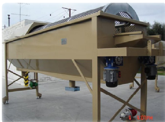
Figura 13. Máquina lavadora-blanqueadora, utilizada en el proceso de blanqueado de la Nuez, utilizado en el proceso de post-cosecha. Fuente: Smart Tiendas, en base a http://raullujan.com.ar/ .
