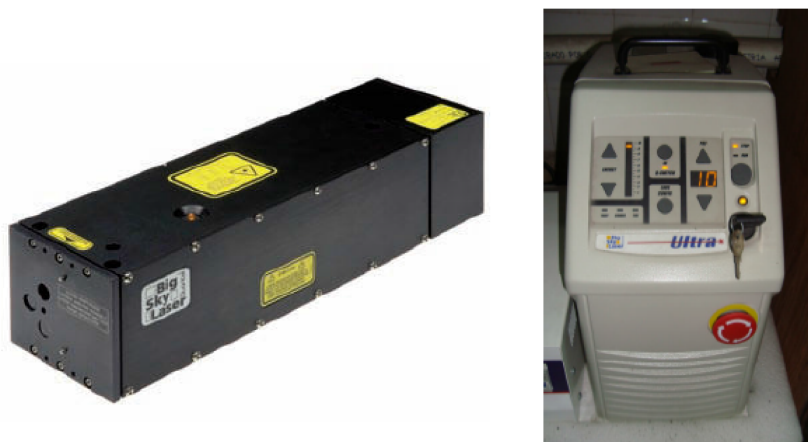
FIGURA 3.4: Láser de estado sólido de Nd:YAG, Big Sky láser, modelo CFR 200, utilizado para ablación láser de muestras sólidas, con el fin de vaporizar metales y/o moléculas orgánicas
