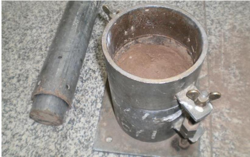
Figura 6.4 Equipo del ensayo del control de compactación.
