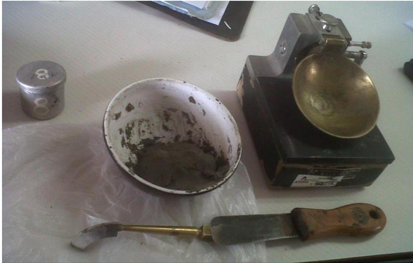
Figura 6.28 Equipo para realizar el ensayo de determinación del valor soporte.
